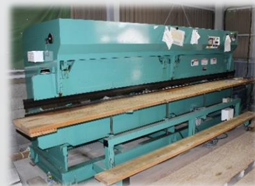
▲長尺屋根の折板現場成型
